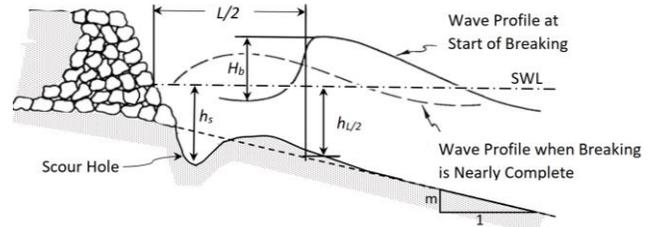
Figure 1 - Definition schema for parameters used herein.
