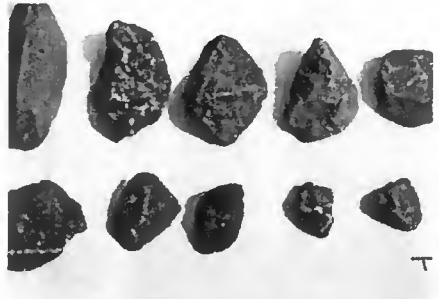
Type 4. Angular; D_{85} / D_{15} = 1.75 L/D > 2 : 50% L/D > 3 : 15%
