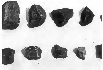
Type 2. Angular; D_{85} / D_{15} = 1.75 L/D > 2 : 20% L/D > 3 : 0%
