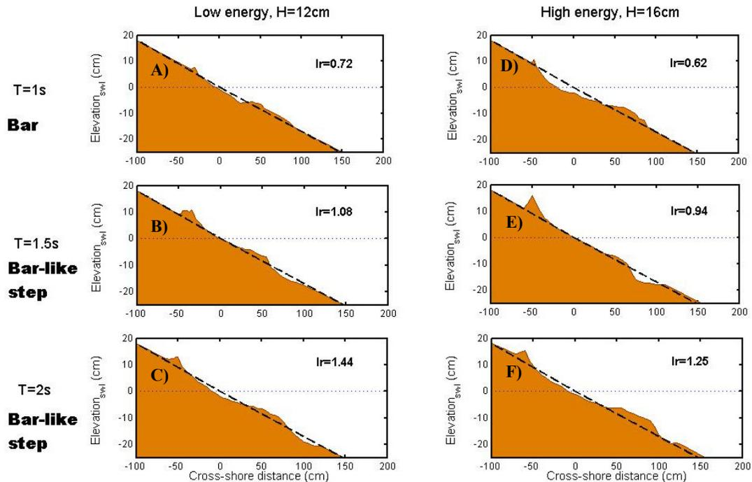
Figure 4. Morphological profile after an equilibrium condition. A) Test H12T10, B) Test H12T15, C) Test H12T20, D) Test H16T10, E) Test H16T15, F) Test H16T20.
