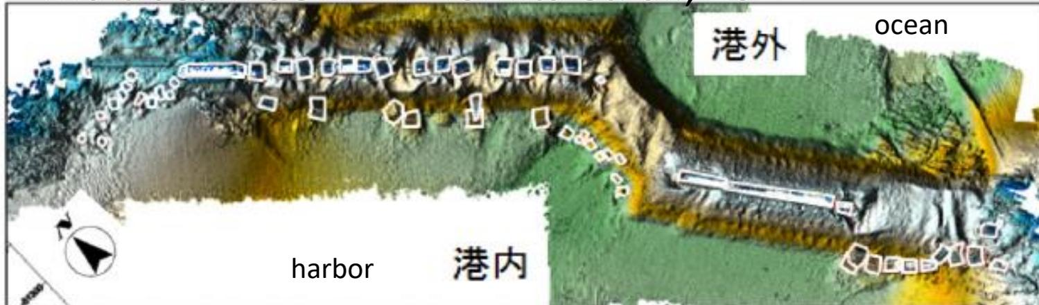
図-1 東北地方太平洋沖地震津波後の釜石湾口防波堤周辺の海底地形図
