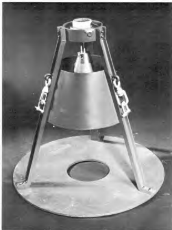
Fig. 2. Partie immergée du houlomètre à ultra-sons.
